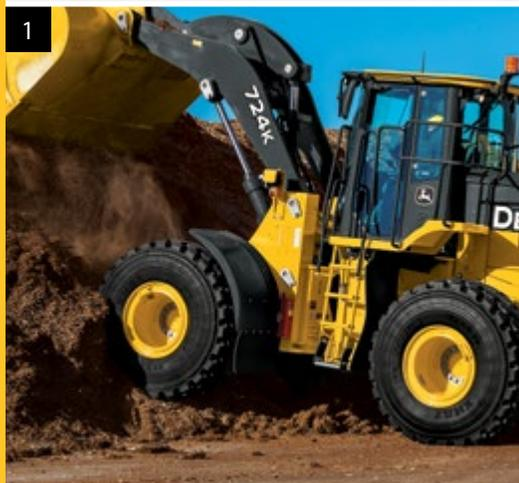
1. Новая функция адаптивного выключения сцепления автоматически направляет больше мощности на поддержание работы гидравлической системы, обеспечивая плавность управления при высоких оборотах двигателя и низких скоростях хода, а также более эффективный контроль за действиями машины на местности с любым рельефом без изменения настроек машины оператором.
