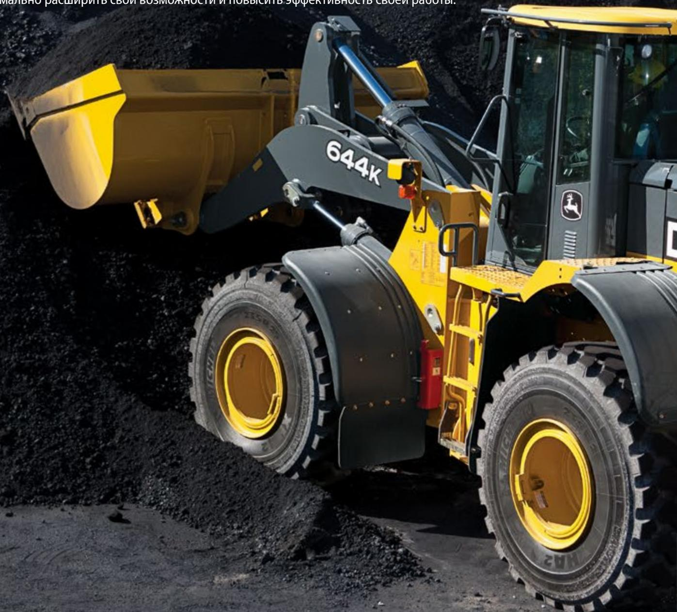
1. Автоматическая блокировка дифференциала срабатывает в момент пробуксовки колес. Такой вид блокировки идеально подходит для неопытных операторов или для выполнения работ в условиях, постоянно требующих высокого тягового усилия, например заготовка силоса, уборка снега и укладка труб.
