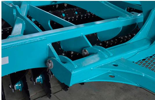
Прочный и надежный узел **крепления сницы к раме** силовыми листами толщиной 25 мм позволяет равномерно распределить тяговые усилия на всю конструкцию рамы.
