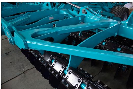
Прочная и мощная пространственная рама состоящая из 5 балок, расположенных в пространстве под разными углами.
