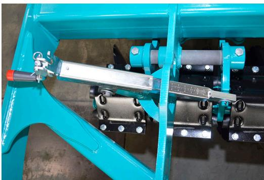
**Смещение рядов** выполнено в виде винтового домкрата, что позволяет добиться полного перекрытия и подрезания почвы на любых глубинах обработки, и сохраняет качество обработки при износе дисков.
