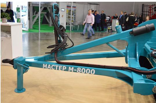
Усиленная узкая сница со сменной серьгой обеспечивает высокую маневренность агрегата при поворотах. Возможна комплектация поперечной планкой для **трехточечной навески** трактора 3 и 4 класса.
