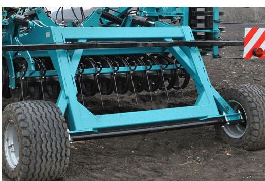
**Широкая, усиленная ходовая тележка со световыми приборами** обеспечивает безопасные перегоны. Она может быть оснащена пневматической тормозной системой с ручным стояночным тормозом и противооткатными башмаками.
