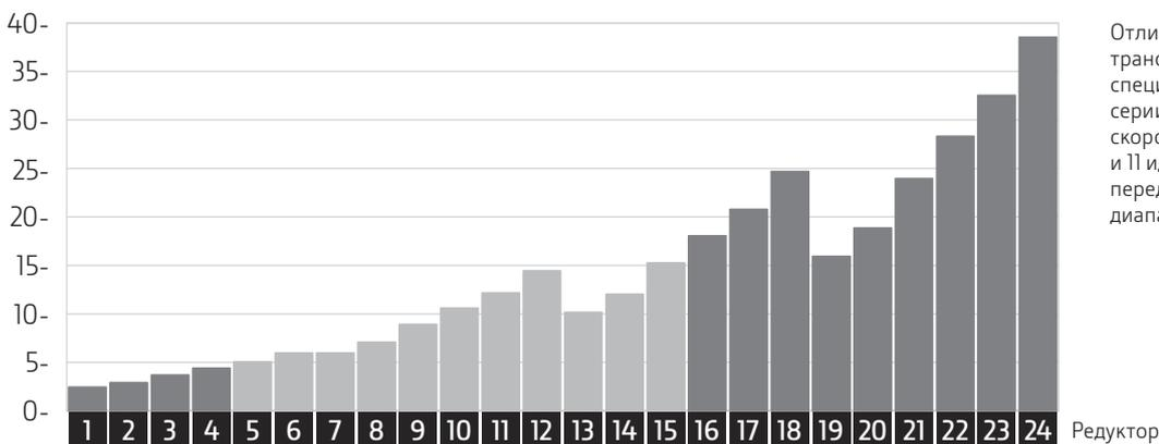
Отличительные черты новой трансмиссии PowrReverser, специально разработанной для серии 6В, – это максимальная скорость движения 40 км и 11 идеально распределенных передач в основном рабочем диапазоне (5–15 км/ч).
